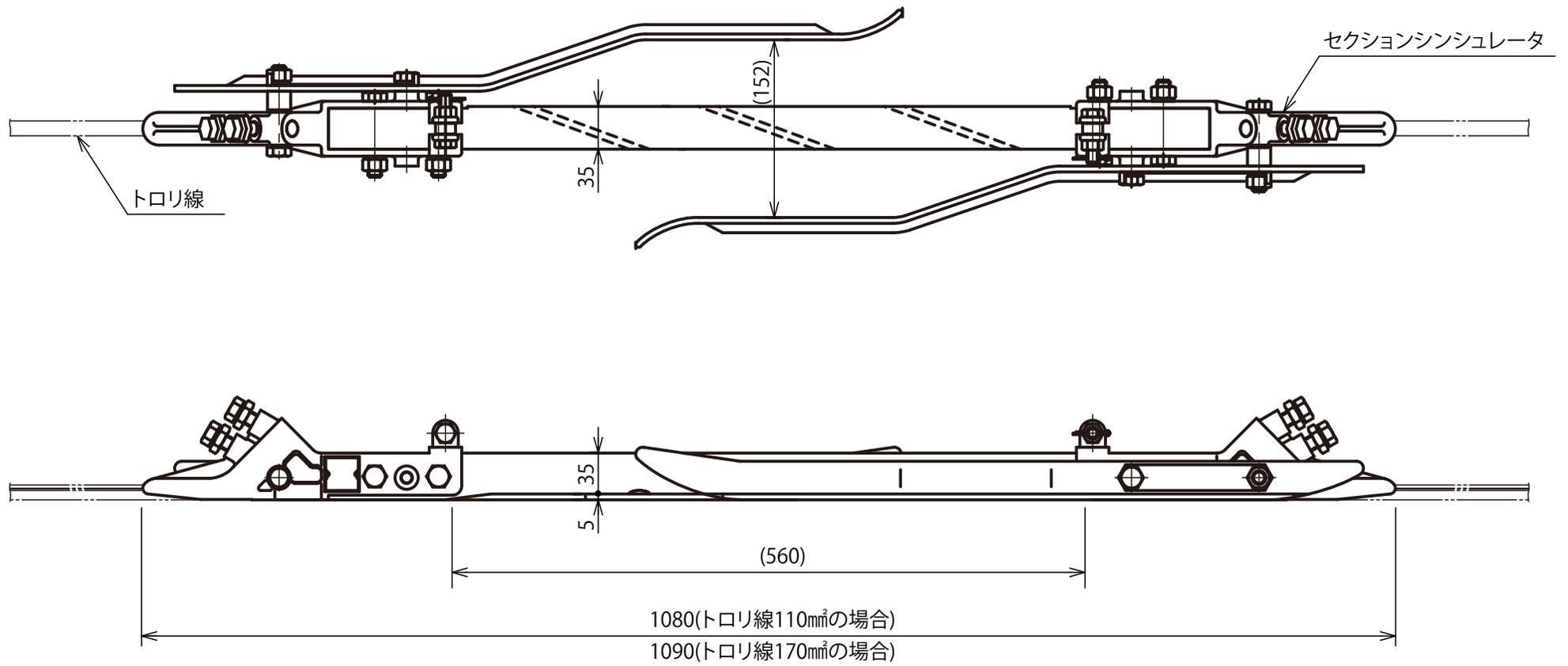
セクションインシュレータ AC20kV 同相用 FRP改良形
