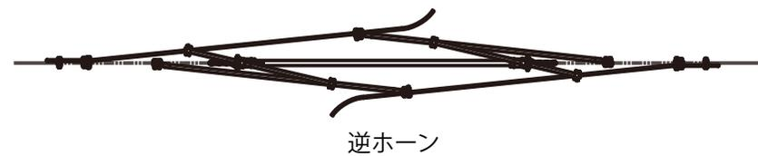
セクションインシュレータ AC20kV 同相用 FRP改良形
