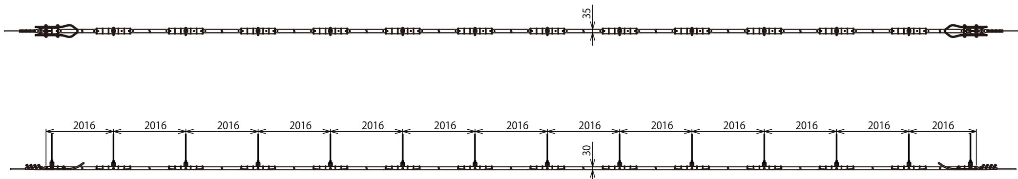
\*セクションインシュレータ AC20kV 交直切替用は、AC20kV異相用の絶縁材本数を増やしたものです。
